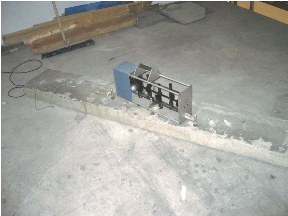
Bild 2: Treppenlager egcoscal T mit Laststufe 300 kg (Messung 1), p = 0,1 \text{ N/mm}^2
