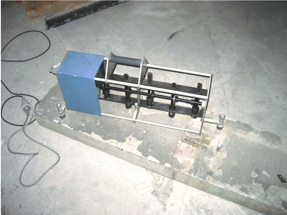
Bild 1: Treppenlager egcoscal T mit Laststufe 300 kg (Messung 1), p = 0,1 \text{ N/mm}^2
