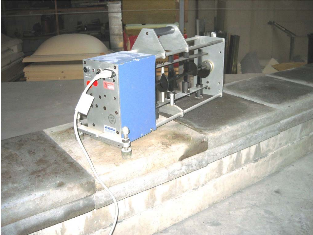
Bild 5: Treppenlager egcoscal T mit Laststufe 900 kg (Messung 3), p = 0,3 \text{ N/mm}^2
