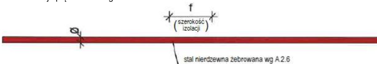
Rysunek A – 30 pręt ściskany wersja 1 – stal nierdzewna
