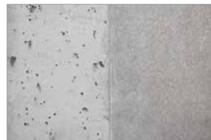
ohne Zemdrain® (links) vs. mit Zemdrain® (rechts)
