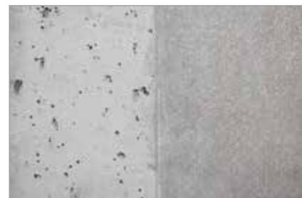
ohne Zemdrain® (links) vs. mit Zemdrain® (rechts)
